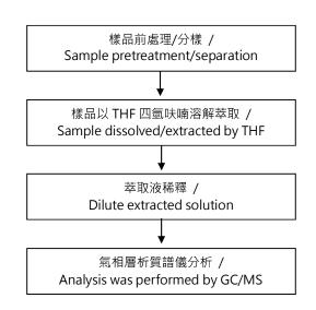
【測試方法/Test method: IEC 62321-8】
